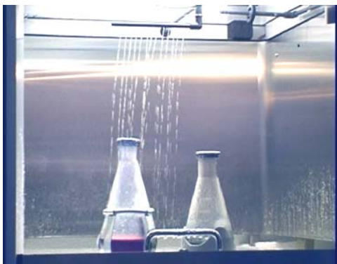
„Im Dauerregen“ Test auf Dichtheit
